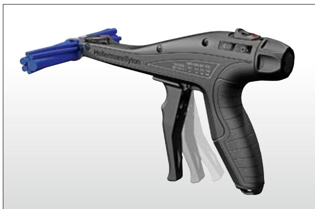
5. Betätigen Sie den Handhebel ein- oder mehrmals. Beim Erreichen der vorgewählten Zugkraft, wird das Bandende bündig am Kabelbinderkopf abgeschnitten.
