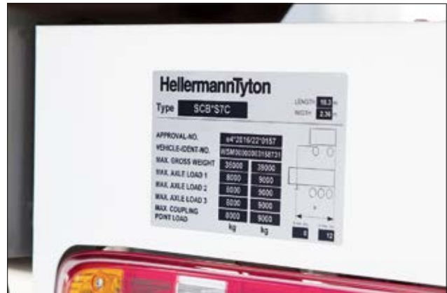
Typenschild eines LKW-Aufliegers mit Helatag Schutzlaminat.
