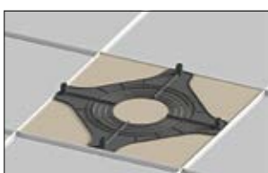
1. Legen Sie die SpotClip-Plate in die gewünschte Position.
