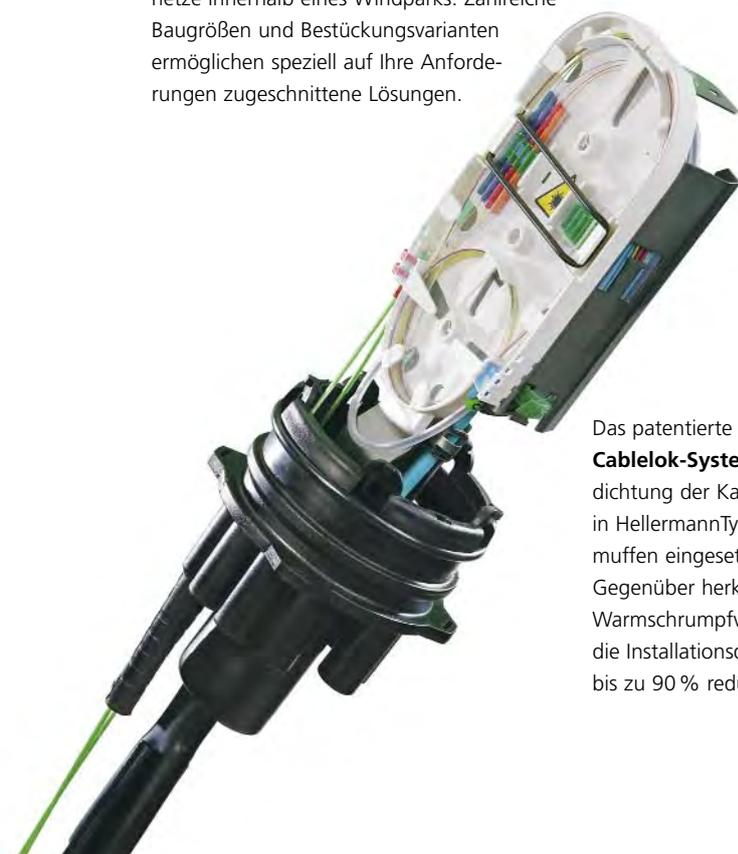
Das patentierte und zeitsparende **Cablelok-System** wird zur Abdichtung der Kabeleinführung in HellermannTyton Glasfaser-Spleißmuffen eingesetzt. Gegenüber herkömmlichen Wärmeschrumpfverfahren kann die Installationsdauer mit Cablelok bis zu 90 % reduziert werden.
