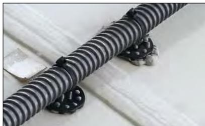
**PMB5-Sockel** werden mit pastösen Industrieklebstoffen fixiert und eignen sich hervorragend für die sichere Befestigung von Leitungen an nicht anbohrbaren Stellen, z. B. zur Anbringung von Sensorkabeln für die Betriebszustandsüberwachung.
