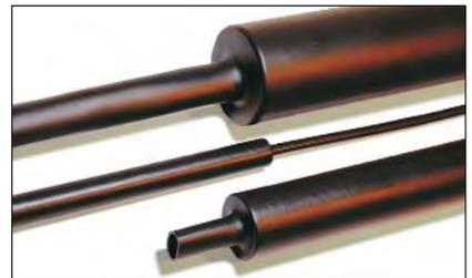
Die mittelwandigen **Schrumpfschläuche MA47** (mit Innenkleber) und **MU47** (ohne Innenkleber) zeichnen sich durch besonders gute Isolationseigenschaften und eine hohe mechanische Festigkeit aus. Sehr gut geeignet für Übergänge und Abschlüsse in der Turmsegmentverkabelung.
