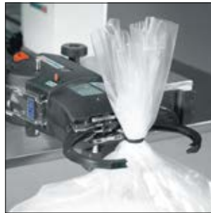
Anwendungsbeispiel: Verschließen von Beuteln mit Montagevorrichtung horizontal 3080.
